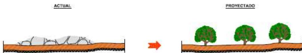
La tierra vegetal localizada bajo la superficie que será cubierta con el nuevo perfil para suavizar el conjunto final del nuevo volumen se retirará previamente y se acopiará para ser reutilizada posteriormente en las labores de integración ambiental de la escombrera.
